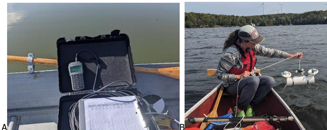
Figure 4: A) prise d'échantillon d'analyse d'eau et des profils avec la sonde Hanna, 2024 B) Bouteille d'échantillonnage d'eau horizontale
