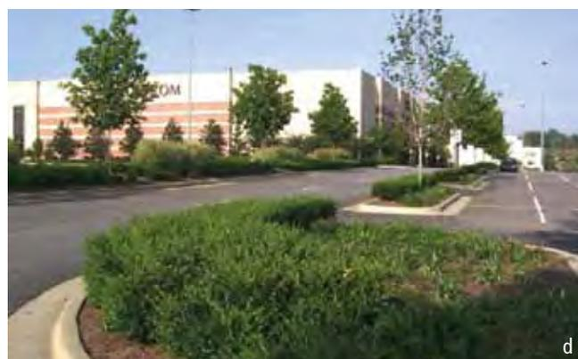
**Figure 4.14** Exemples de réduction des surfaces imperméables. (a) Cul-de-sac avec aménagement de l'îlot; (b) terre-plein aménagé; (c) rues résidentielles moins larges; (d) stationnement «vert» avec aménagement des îlots).
