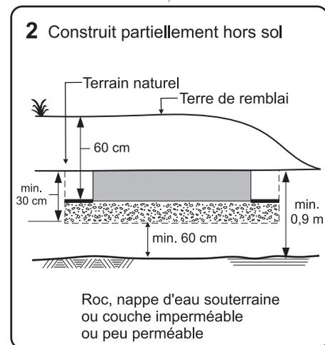
Figure B.10.8 : Détails de construction du lit d'absorption lorsque le système est composé d'unités espacées
