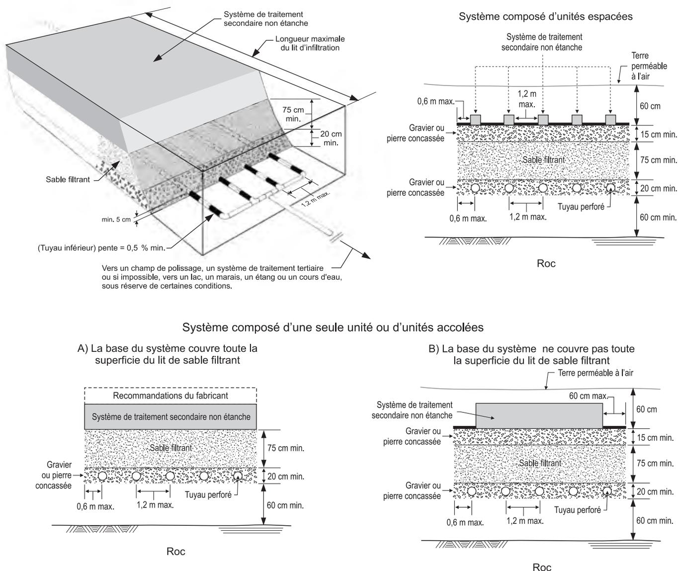
Dans le cas où le filtre à sable classique est construit entièrement ou partiellement hors sol, la pente du remblai de sol imperméable ou peu perméable sur chacun des côtés du filtre doit être d'au moins 1 : 2.
