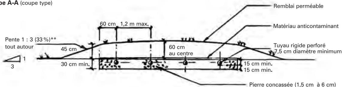
La profondeur est établie selon le niveau de roc, des eaux souterraines ou de la couche de sol imperméable
