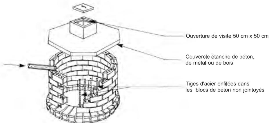
**Puits absorbant construit en parallèle**
