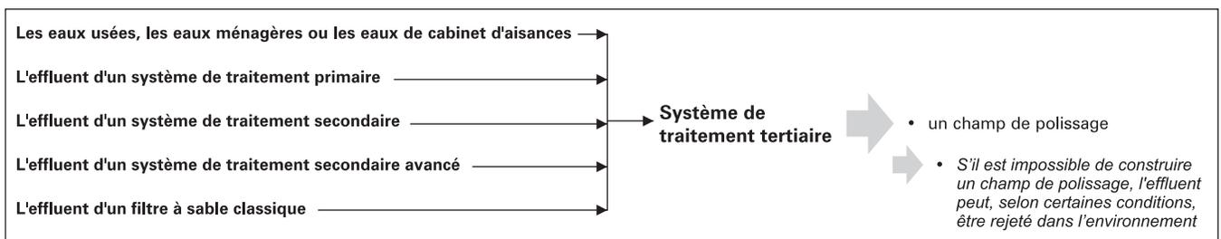
Dans le cas où il est impossible d'installer un champ de polissage, l'effluent des systèmes mentionnés ci-haut peut être rejeté dans un cours d'eau ou un fossé selon les conditions listées dans le tableau B.3.1. (Voir aussi la [section 21 « Les autres rejets à l'environnement »](#).)
