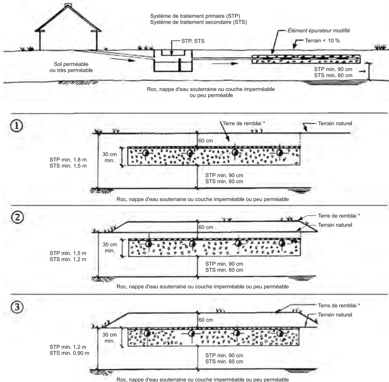
\* Terre de remblai perméable à l'air
