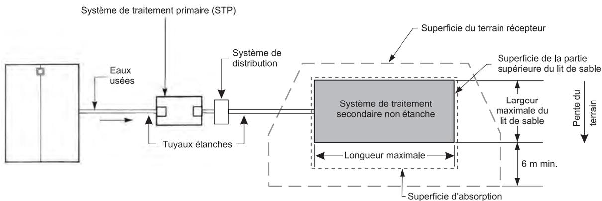
La base du système couvre toute la superficie d'absorption du lit de sable filtrant
