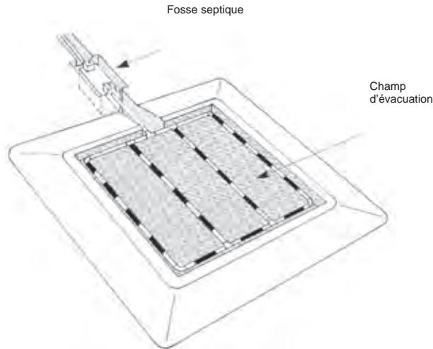
*Le matériau anticontaminant peut être un papier fort non traité, au moins 5 cm de paille ou un matériel synthétique (géotextile). Le matériau anticontaminant vise à créer une barrière contre la contamination du gravier ou de la pierre concassée par le matériau de remblai et à éviter le colmatage du terrain récepteur par des particules fines.*
