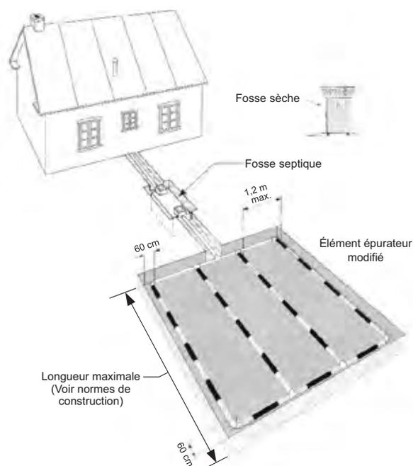
fosse septique doit être de 2,3 mètres cubes. De plus, la superficie disponible du terrain récepteur de l'élément épurateur modifié doit être conforme aux normes du tableau B.14.1 en fonction du nombre de chambres à coucher de la résidence isolée desservie ou du débit total quotidien d'un autre bâtiment desservi.
