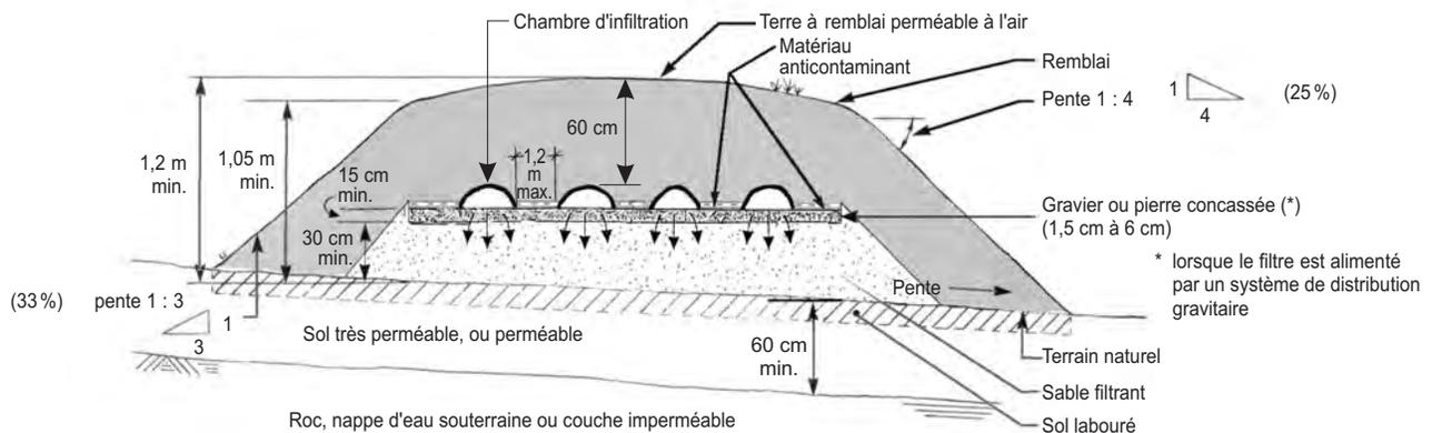
Dans le cas où les chambres d'infiltration sont accolées, la couche de gravier ou de pierre concassée de 15 cm n'est pas requise (Pour plus de détails, voir l'annexe B-5).
