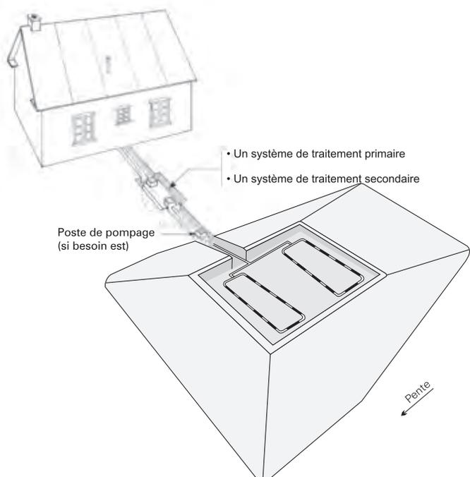
Compte tenu de l'élévation du système de distribution, le filtre à sable hors sol doit, lorsque la pente du sol naturel ne permet pas une alimentation gravitaire, intégrer un poste de pompage pour acheminer les eaux vers le filtre à sable hors sol.
