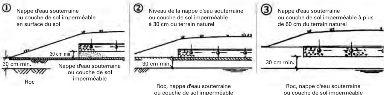
\*\* Lorsque le terrain est en pente, la pente du remblai du côté situé dans le sens de la pente doit avoir un rapport 1:4 (25%)
