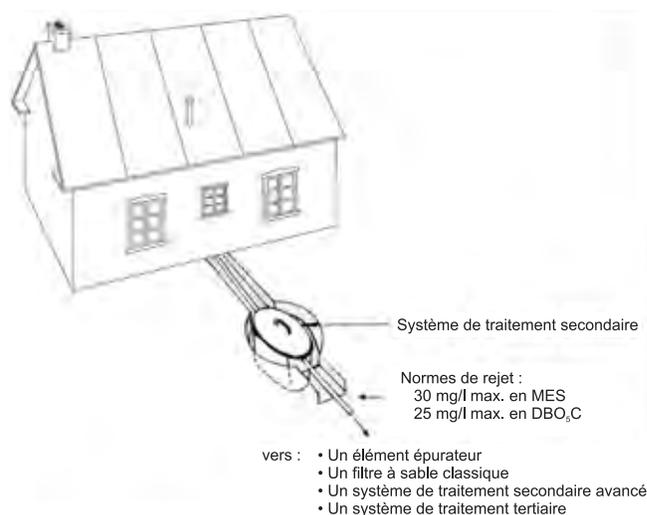
L'échantillonnage d'un système de traitement secondaire n'est pas requis d'une manière systématique. Cependant, tout système de traitement secondaire doit être muni d'un tel dispositif pour permettre l'échantillonnage à des fins de suivi de performance ou d'enquête.
