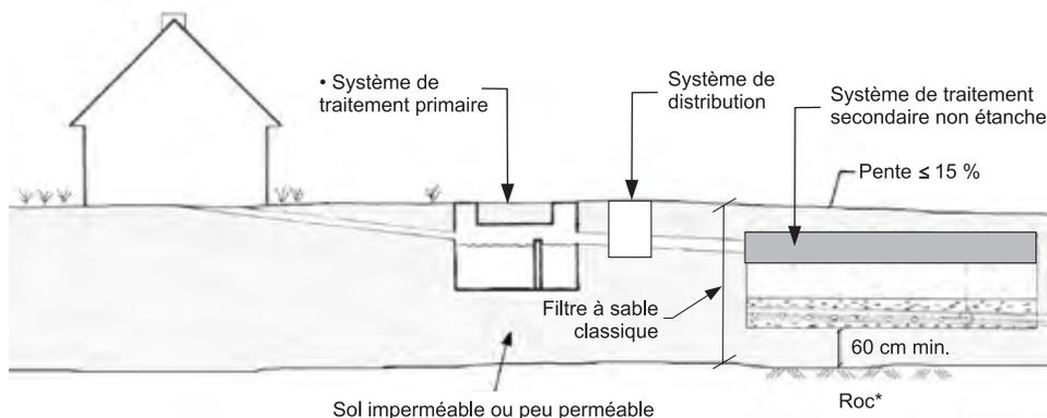
\* Le roc doit se trouver à au moins 60 cm sous la surface du terrain récepteur.
