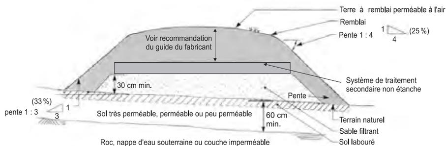
La base du système ne couvre pas toute la superficie d'absorption du lit de sable filtrant
