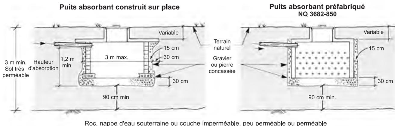
**Puits absorbant construit sur place**
