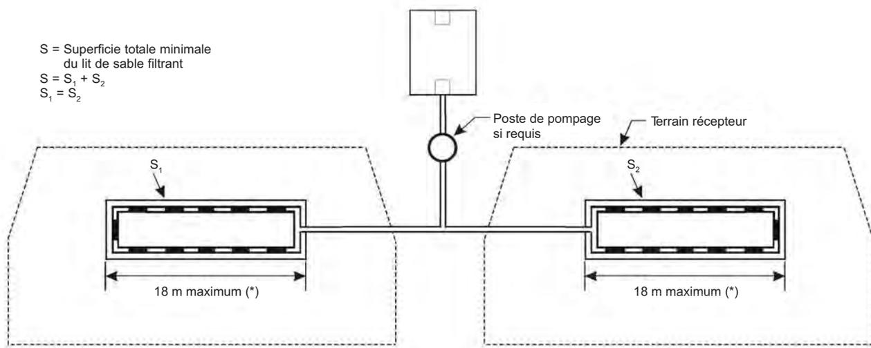
\* Lorsque le filtre à sable hors sol est construit avec un système de distribution sous faible pression, la longueur maximale de 18 mètres n'est pas applicable.
